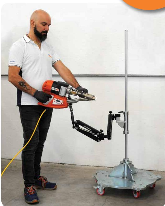
CADDY ARM & VEST è la soluzione studiata da Ritmo per chi usa gli estrusori in continuo. Il sistema grazie ad un braccio ammortizzato e snodato permette movimenti complessi e fluidi senza sforzo alle braccia. Si usa con gli estrusori della serie Link e Solo.
