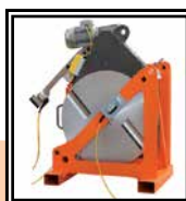
Soporte Placa térmica y Fresadora
