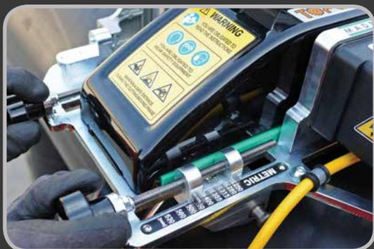
Fácil e intuitiva regulación del campo de trabajo. Esta operación se ejecuta en obra, después de haber fijado el anillo específico por cada medida de tubo
